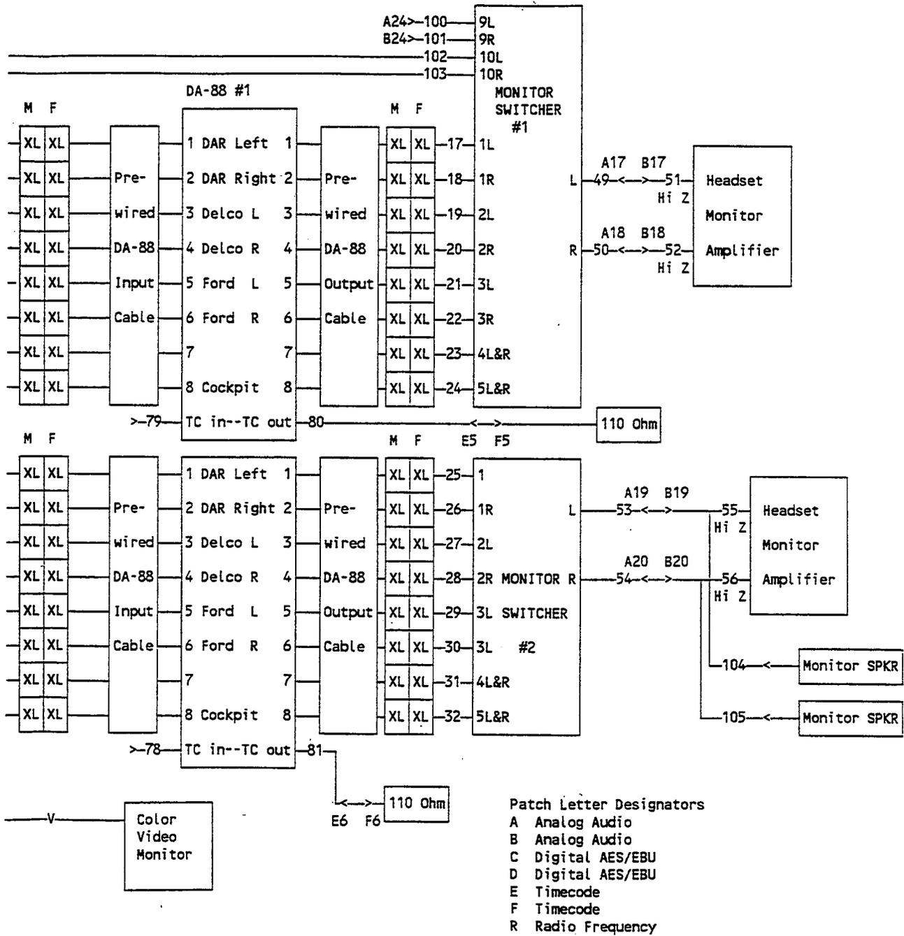
EIA-DAR FIELD TEST; TESTBED BLOCK DIAGRAM
